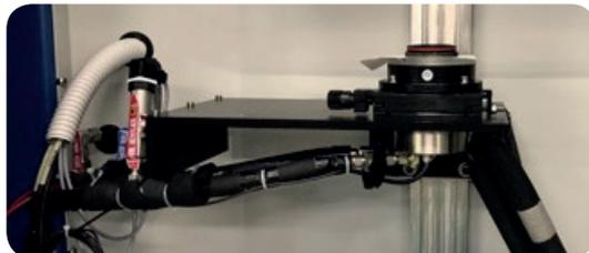
Рис. 25. Фильера для нанесения защитного акрилатного покрытия (первичного и вторичного)
