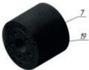
Изображение верхней камеры, верхний торец, где 7 - отверстие калиброванное в верхней камере; 19 - отверстие крепежное.
