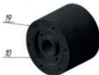
Изображение верхней камеры, нижний торец, где 10 - канавка радиусная на нижнем торце верхней камеры; 19 - отверстие крепежное.
