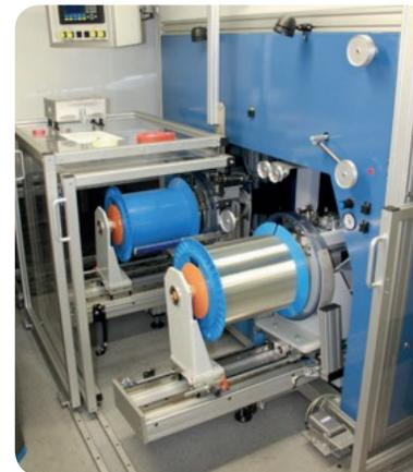
Рис. 28. Приемное устройство. Максимальная скорость 2100 м/мин, приёмные катушки по 250 км.
