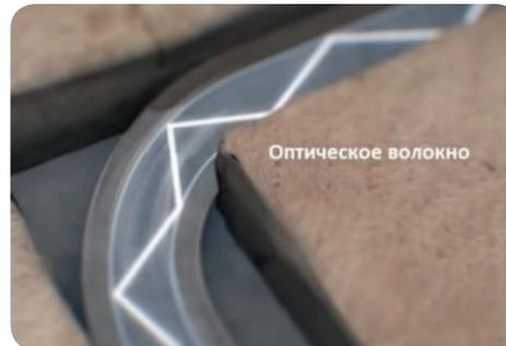
Рис. 4. Распространение света по ОВ посредством многократных отражений.
