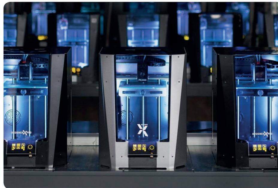
**Designer X** – базовый 3D-принтер линейки X от российской компании PICA-SO 3D. Наличие датчиков и систем контроля за работой принтера позволяет свести к минимуму процент «брака» печати и добиться качества, которое ранее было недоступно для настольных 3D принтеров. Область печати составляет 200×200×210 мм, толщина слоя от 10 микрон, скорость печати до 100 см<sup>3</sup>/час. Спектр расходных материалов включает в себя любые термопластики, вплоть до температуры плавления 410 градусов
