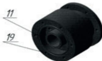
Изображение средней камеры, нижний торец, где 11 - канавка радиусная на нижнем торце средней камеры; 19 - отверстие крепежное.
