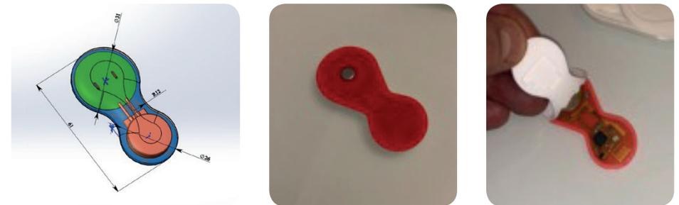
Чертеж и готовый макет устройства с зарядным кейсом (пластырь гибкий в месте соединения двух окружностей)
