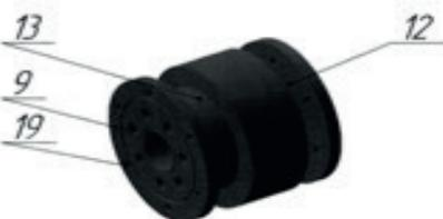
Изображение нижней камеры, верхний торец, где 9 - отверстие калиброванное в средней камере; 12 - канавка радиусная на внешней цилиндрической поверхности в нижней части нижней камеры; 13 - канавка радиусная на внешней цилиндрической поверхности в верхней части нижней камеры; 19 - отверстие крепежное.
