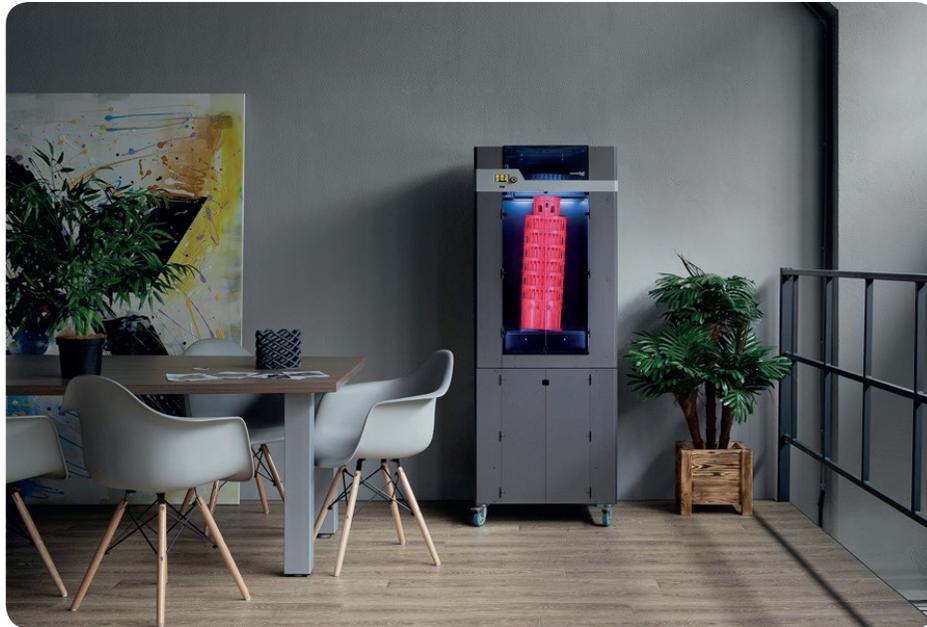
**Designer X PRO** - флагманский 3D-принтер от российской компании PICASO 3D. Устройство оснащено двумя соплами, работающими по технологии JetSwitch. Область печати составляет 200×200×210 мм, скорость печати 100 см<sup>3</sup>/час, время переключения между соплами составляет всего 5 секунд, что делает его самым быстрым двухматериальным принтером на рынке по технологии FDM/FFF. Спектр расходных материалов включает в себя любые термопластики, вплоть до температуры плавления 410 градусов.
