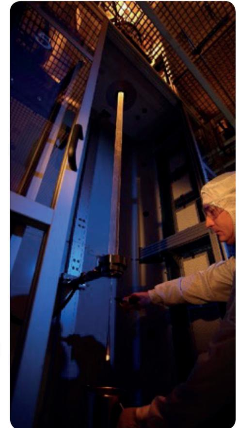
Рис. 23. «Капля» расплавленного стекла в начале вытяжки
