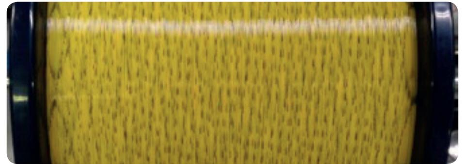
Рис. 14. Внешний вид окрашенного в желтый цвет волокна с нанесенными штрихами (Ring Marking).
