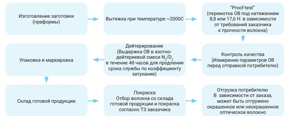
Рис. 11. Упрощенная технологическая схема получения оптического волокна
