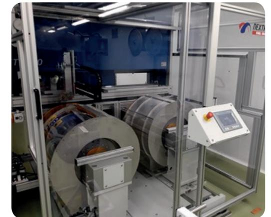
Рис. 29. Приемное устройство на высокоскоростной линии вытяжки. Максимальная скорость 2500 м/мин, приёмные катушки по 1000 км.
