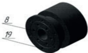
Изображение средней камеры, верхний торец, где 8 - отверстие калиброванное в средней камере; 19 - отверстие крепежное.
