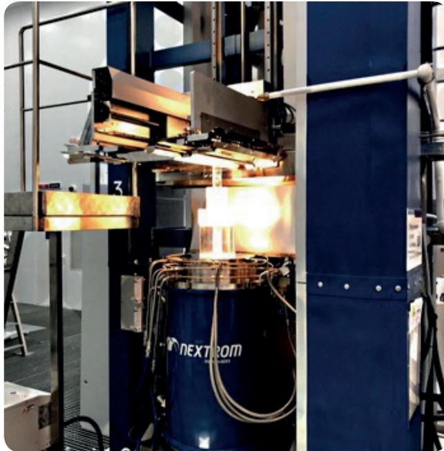
Рис. 24. Индукционная графитовая печь NIF 120 с преформой
