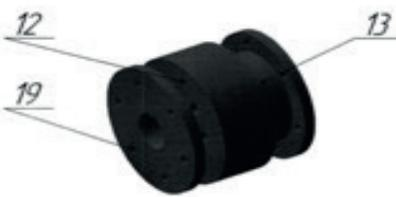
Изображение нижней камеры, нижний торец, 12 - канавка радиусная на внешней цилиндрической поверхности в нижней части нижней камеры; 13 - канавка радиусная на внешней цилиндрической поверхности в верхней части нижней камеры; 19 - отверстие крепежное.
